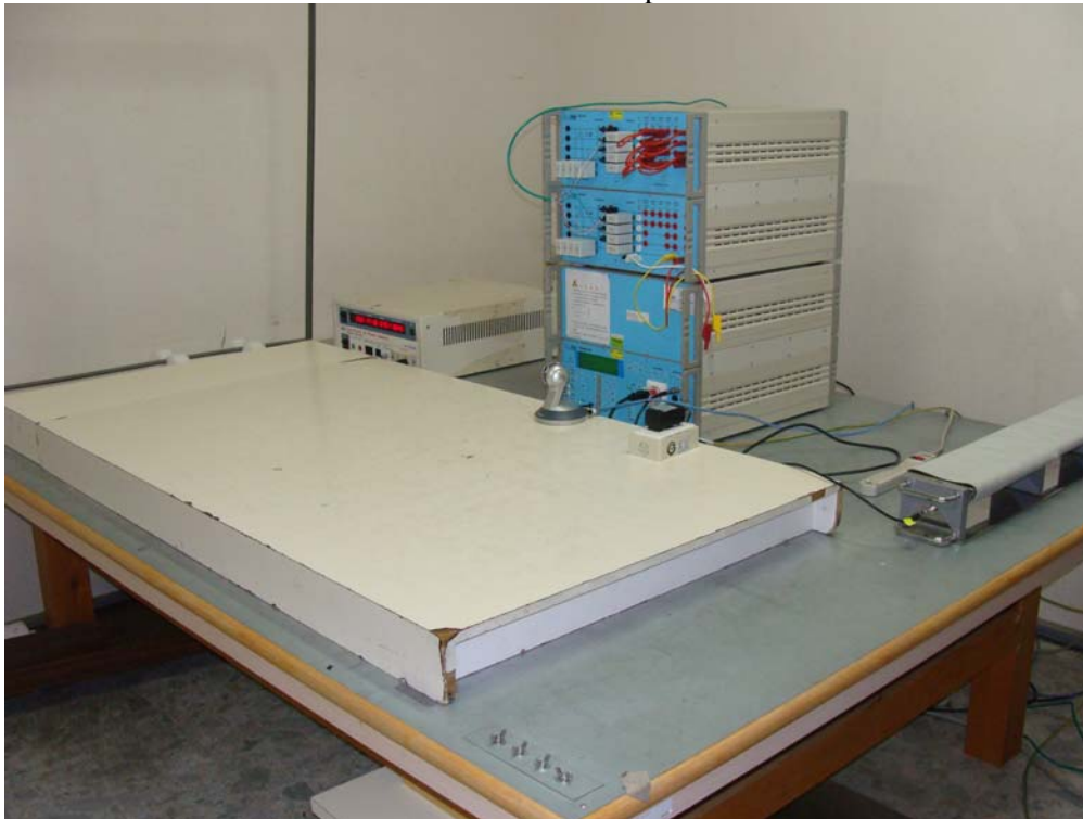
EFT/B Test Setup
