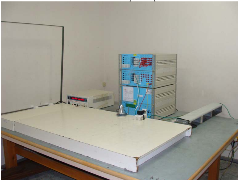
EFT/B Test Setup - Clamp
